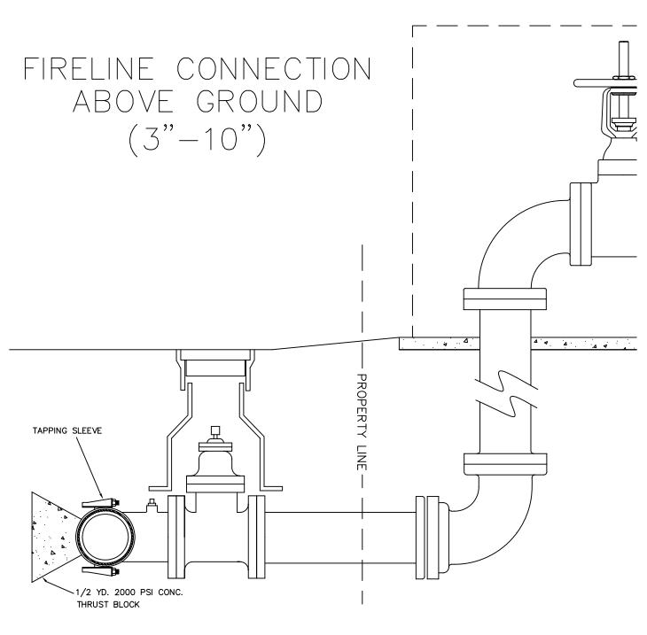
\*RESTRAIN ALL JOINTS. (I.E. RESTRAINING GLANDS, FIELD-LOC GASKETS, OR RESTRAINT JOINT PIPE.)
